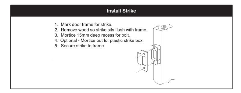
**IMPORTANT:** A MAXIMUM CLEARANCE OF 5mm IS RECOMMENDED BETWEEN LOCK FOREND AND STRIKER PLATE FOR SECURITY REASONS.
